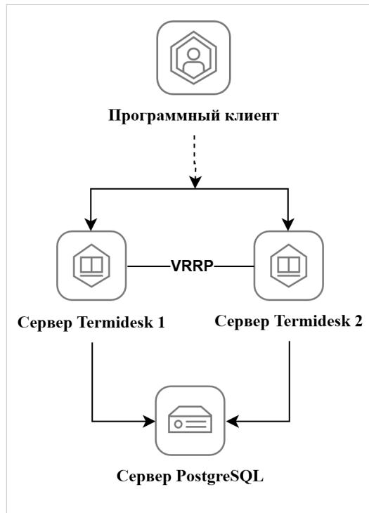
Рисунок 13 – Отказоустойчивая схема установки Termidesk
