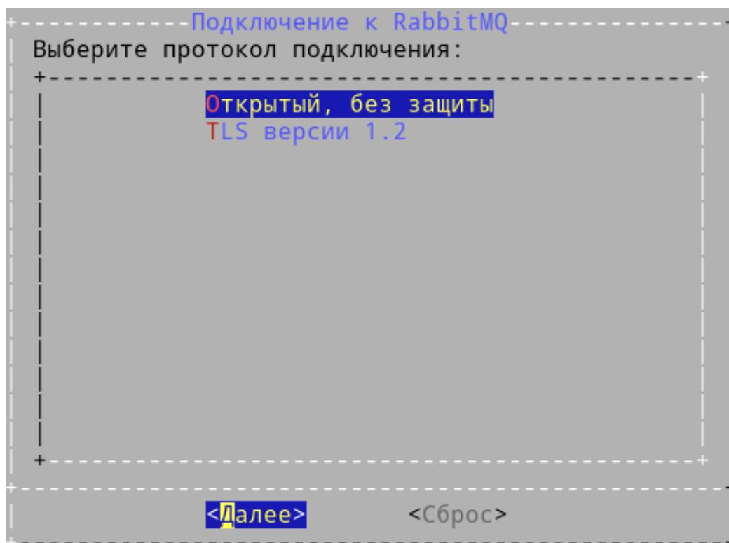
Рисунок 8 – Выбор протокола для подключения к RabbitMQ
