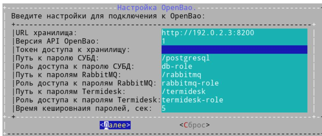
Рисунок 4 – Настройка подключения к OpenBaо
