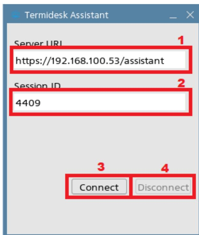
Рисунок 3 – Графический интерфейс клиентской части удаленного помощника
