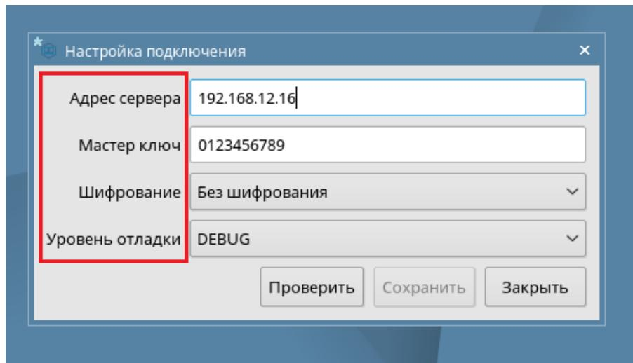
Рис. 3.7 – Конфигурация агента Термидеск для ОС Astra Linux
